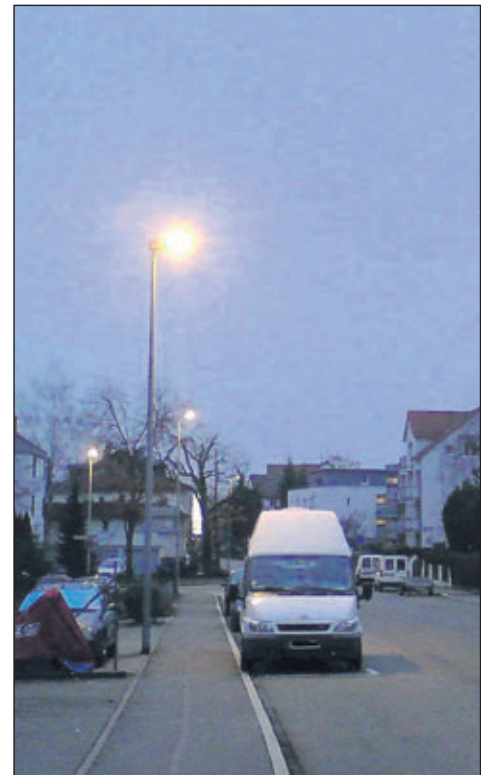
Nicht nur wie hier in der Beinsteiner Straße sind die Leuchtkörper an den Straßenlampen schon gegen energiesparendere ausgetauscht worden. Die neuen Natrium-Hochdruckdampfampfen spenden insektenfreundliches gelbes Licht bei geringerem Stromverbrauch. Foto: Launer
