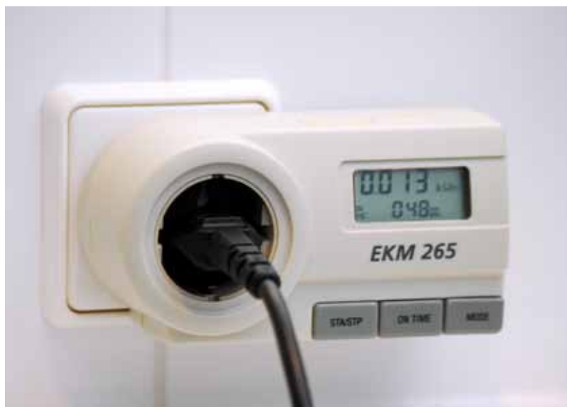
Gerät zum Messen des Stromverbrauchs in Stand-by oder in Betrieb, auszuleihen bei Energieagenturen, kommunalen Energiereferaten oder Energieversorgungsunternehmen
