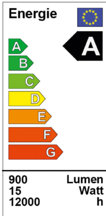
Das EU-Label für eine effiziente Lampe mit Angabe des Lichtstroms (900 Lumen), des Leistungsbezugs (15 Watt) und der Standzeit (12000 Stunden)
